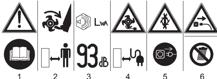
**1** Leggere attentamente il libretto uso e istruzione prima di usare la macchina - Read the instructions manual before operating on the machine - Lesen Sie die Gebrauchsanweisung vor der Inbetriebnahme - Lire le mode d'emploi avant l'usage - Leer atentamente el manual de instrucciones antes de utilizar la máquina.
