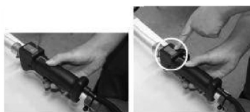
Fig. 19 Appuyez sur le bouton de déverrouillage et accélérez. Poussez le verrouillage des gaz au centre dans cette position (froid).
