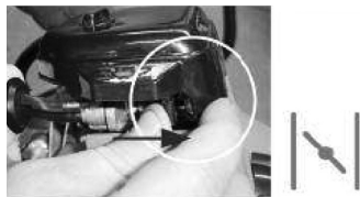
Fig. 17 Mettez le starter du carburateur en position de démarrage.
