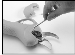
9. Instale a aba de travamento da porca.
