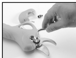
3. Remove the blade nut.
