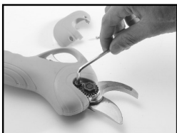
9. Instale la pestaña de bloqueo de tuerca.
