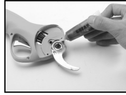
6. Lors du remplacement des lames, de l'huile de lubrification doit être ajoutée entre elles.
