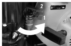
(1) Passagem de combustível (2) Passagem de ar (ON)
