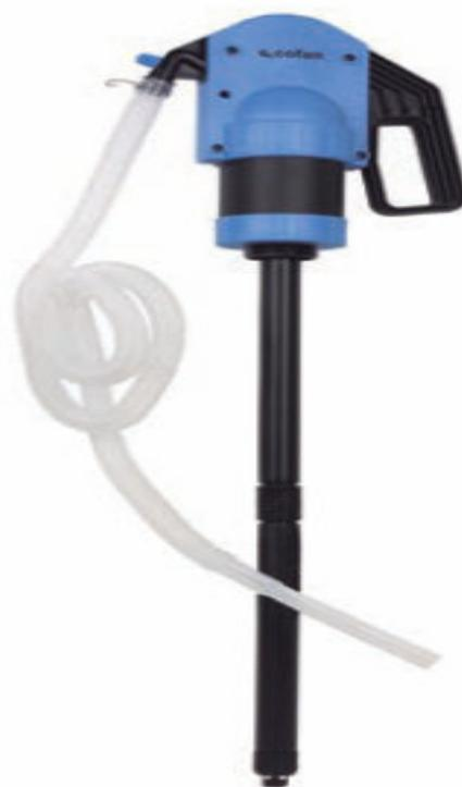
Bomba plástica de palanca para barriles de 50 y 205 litros con rosca de 2" y tuerca para una correcta fijación. Diseñada para su uso con aceites de baja viscosidad, productos químicos, detergentes, jabones, anticongelantes, limpiaparabrisas, aceites hidráulicos, lubricantes, herbicidas y plaguicidas, AdBlue, Urea, etc. Exclusivamente para utilizar con materiales no inflamables. Se suministra con tubo de succión extensible y manguera de descarga flexible de 2 metros de longitud.
