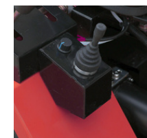
JOYSTICK REGULABLE PARA HIDRÁULICO TRASERO Y DELANTERO
