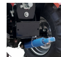
DOBLE SISTEMA HIDRÁULICO DELANTERO Y TRASERO
