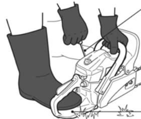
8. Mientras sostiene la motosierra de manera segura en el suelo, agarre el mango del arrancador, tire lentamente el cable con su mano derecha hasta sienta algo de resistencia (los trinquetes del arranque agarran), y ahora, rápida y poderosamente tire la cuerda. **Nunca enrede su mano en la cuerda.**
