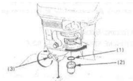
3. Tirar del puño de puesta en marcha hasta notar una cierta resistencia. Seguir tirando hasta que la muesca en la polea de arranque coincida con el agujero en el dispositivo de arranque autoenrollador. Entonces las válvulas de admisión y escape están cerradas lo que contribuye en proteger el motor contra la corrosión interna.
